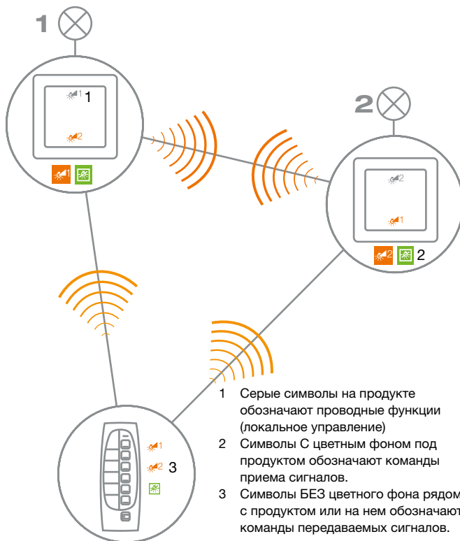
Рис 3: Пример конфигурации передатчик/приемник
