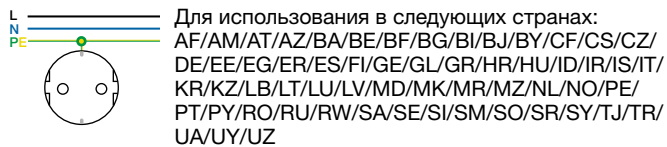
Рис 1: Розетка SCHUKO* с 2 полюсами + заземление, 250 В~, 16 А
